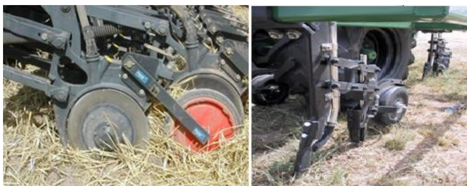
شکل ۱۰- شیار بازکن‌های نوع تیغه‌ای تی وارون (سمت راست) و بشقابی (سمت چپ). Figure 10- Seed drill openers inverted T-shaped type (right) and disc type (left).
