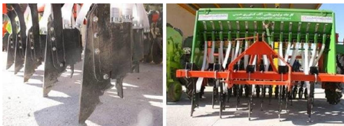
شکل ۶- کارنده کشت مستقیم مدل HOSAINI 15 شرکت ادوات سازی حسینی مجهز به شیاربازکن کاردی دارای ۳ باله
