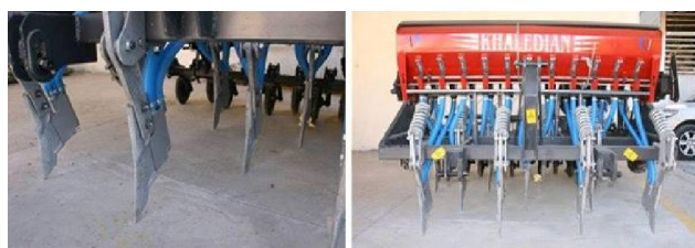
شکل ۱۱- کارنده کشت مستقیم مدل SINA II ساخت شرکت ماشین خالدیان مجهز به شیاربازکن کاردی دارای ۲ باله
