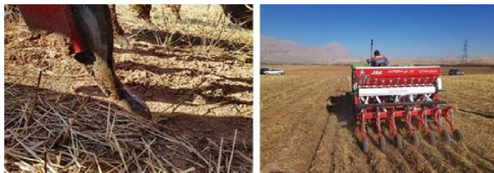
شکل ۵- کارنده کشت مستقیم مدل PNJ984 ساخت شرکت جیران صنعت مجهز به شیاربازکن کاردی سی شکل
