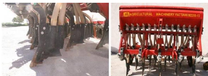
شکل ۷- کارنده کشت مستقیم M2200-13 شرکت ادوات کشاورزی فتاحی مجهز به شیاربازکن کاردی دارای ۲ باله
