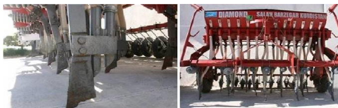
شکل ۸- کارنده کشت مستقیم مدل DIAMOND شرکت صلاح برزگر کردستان مجهز به شیاربازکن کاردی نوک‌دار ساده
