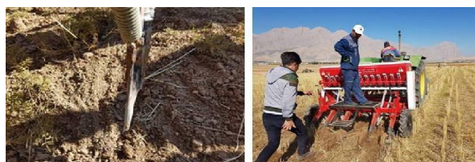
شکل ۹- کارنده کشت مستقیم مدل ZST2000 ساخت شرکت ظریف صنعت مجهز به شیار بازکن کاردی L شکل تخت
